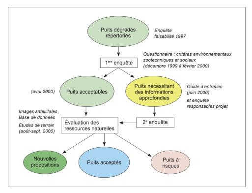
Schéma 3. Démarche schématique pour la sélection des sites de travaux (PHPK)
