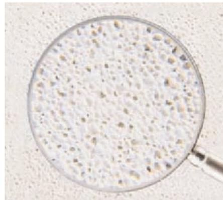
Figure 10 : Mur en blocs de béton cellulaire et gros plan sur le matériau au cycle de vie économe en énergie. Matériau fabriqué en Turquie
