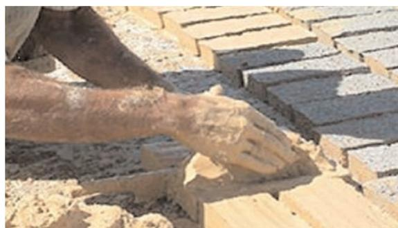
Figure 9 : Briques de Tozeur fabriquées manuellement
